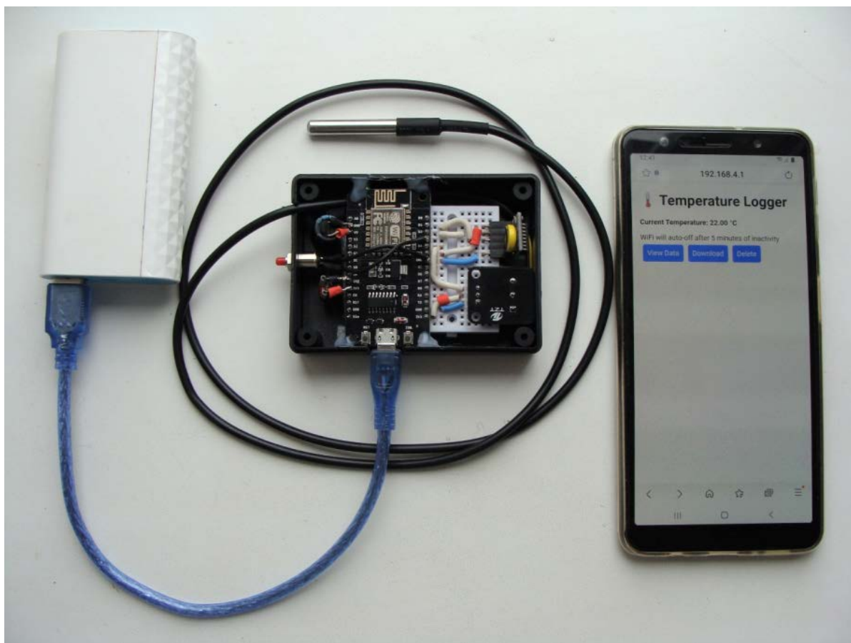
Рисунок 7. Температурный логгер медицинского транспортного контейнера
